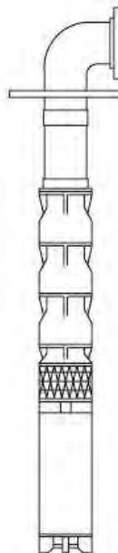
Figure 2.2.9.1.1.1 — Submersible turbine (VS0)
